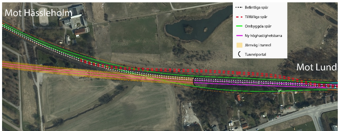
Figur 38 Planskild korsning mellan höghastighetsbanan och Södra stambanan norr om Lund.
