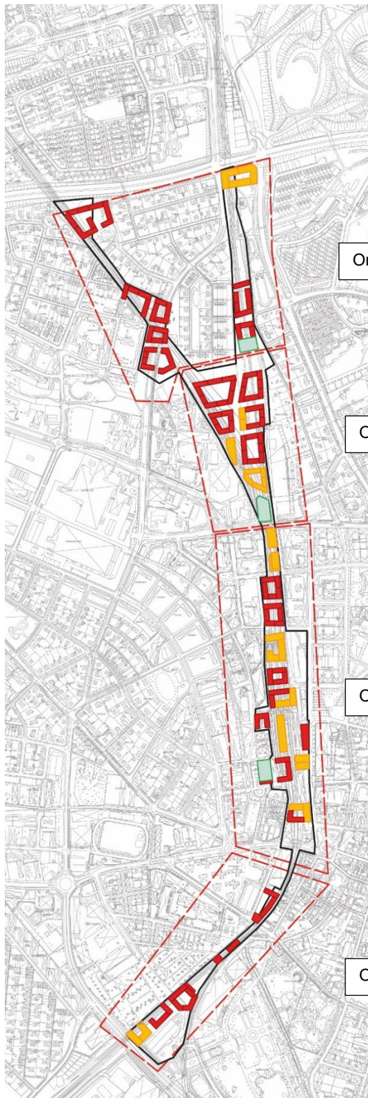
Figur 30 Situationsplan till exploateringsförslaget Lundaskala, röda byggnader visar bostäder och gula kontor eller service.
